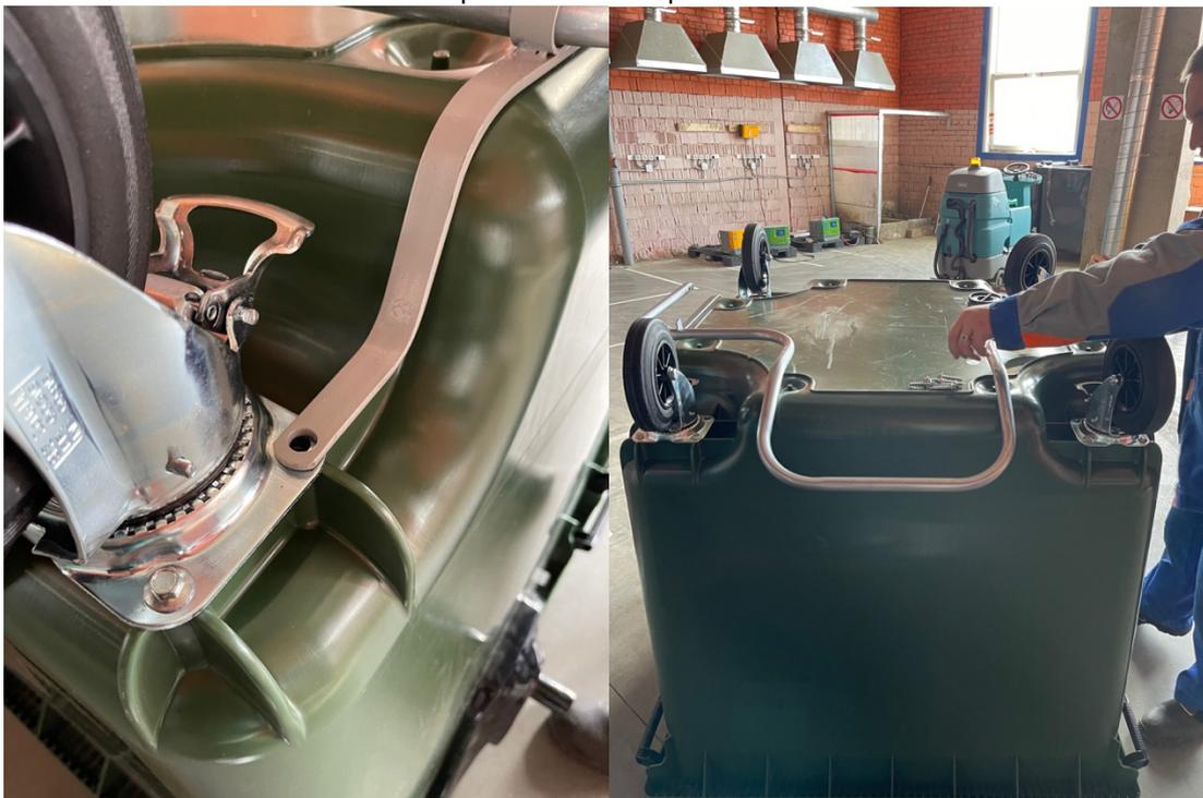
3. Перевернуть контейнер и продеть толкатель открывания крышки через специальное отверстие в корпусе контейнера.
