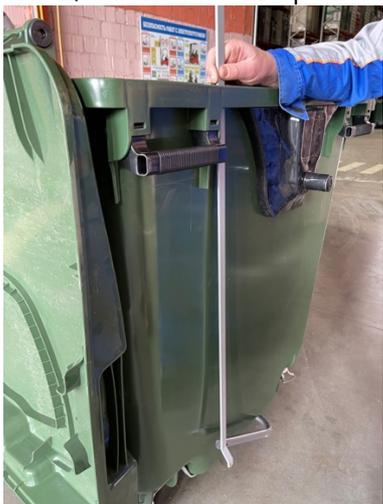
4. Закрепить с каждой стороны толкатель открывания крышки к педали открывания с помощью болтов 40x8 мм.
